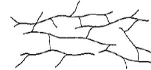
Jonction entre les différentes chaînes moléculaires lorsque la longueur et la fréquence des branches augmentent.
